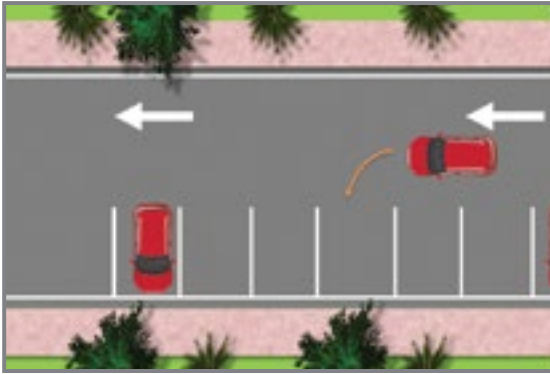
চিত্র ৩.২৫ রাস্তার উপর সমকৌণিক গাড়ী পার্কিং ও তার মার্কিং
