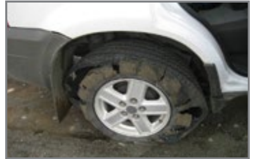
চিত্র ৮.৯ পিছনের চাকা পাংচার হওয়ার একটি উদাহরণ
