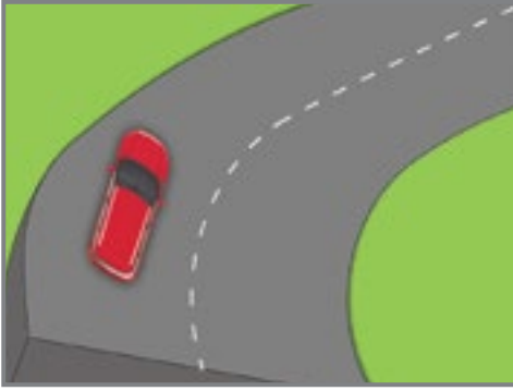
চিত্র ১.৮ হরাইজন্টাল কার্ভযুক্ত রাস্তায় সুপারএলিভেশন
