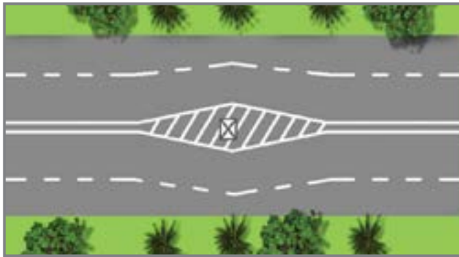
चित्र 3.22: कोणीय चिह्नांकन के साथ चिह्नित अवरोध एप्रोच
